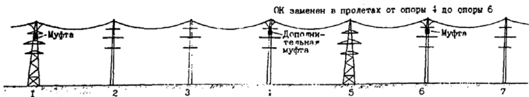
б) Состояние линии после замены ОК
